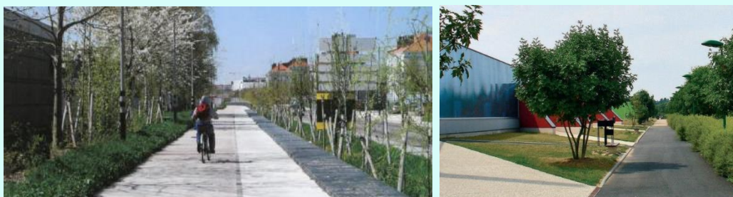
Dissociation de l'espace piéton (et cyclable) et de l'espace circulé par de la végétalisation et l'utilisation de matériaux différents
